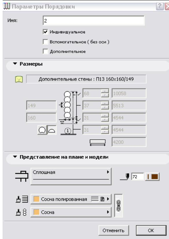
Следует отметить, что выпуск автоматически суммируется с длиной бревна и в порядовке увидим длину всего бревна. Например, если в Параметрах проекта введено значение максимальной длины 6000 мм, то длина стены на плане между осями (центрами бревен) 5400 мм+300мм (левый выпуск)+300мм (правый выпуск)= 6000 мм. Такая стена в порядовке не будет высвечиваться красным цветом, так как проходит по длине и не подлежит обязательной резке.
