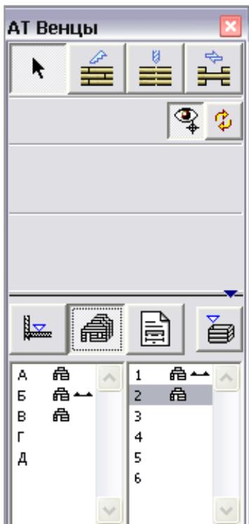
Панель с кнопками перехода к вышеуказанным режимам появляется только в режиме порядовки и становится доступна в том случае, если пользователь открывает окно *порядовки Бревенчатой стены*.
